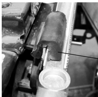
Опора кожуха вентилятора
