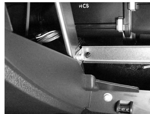
3.6.6 Отсоединить колодки жгута панели приборов от резистора добавочного и электродвигателя вентилятора.
