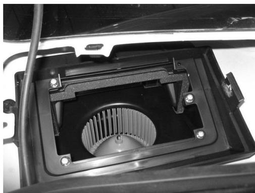
3.6.4 Снять крышку вещевого ящика панели приборов в сборе.
