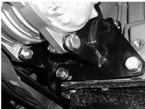
3.5.12 Установку генератора произвести в порядке обратном снятию, при этом заменив гайку 4, рис. 2, винтом натяжителя из комплекта поставки. Момент затяжки болта крепления генератора 6 58,3-72 Нм (6,0-7,4 кгс·м), гайки 5 32,2-51,9 Нм (3,3-5,5 кгс·м) (ключ гаечный 22 ГОСТ 2839-80, головка сменная 13, вороток, ключ динамометрический 02.7812-4013), рис. 2.
