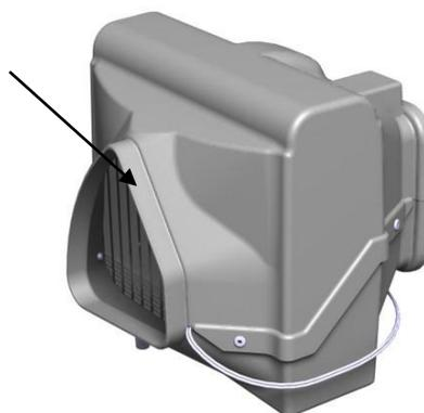
3.6.11 Установить блок испарительный вместо промежуточного воздуховода. Присоединить трубку сливную к блоку испарительному.
