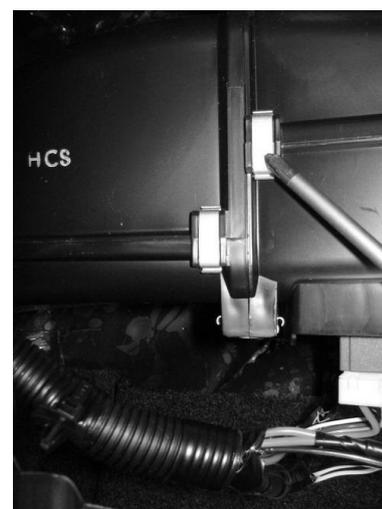
3.6.8 Удалить заглушку в щитке передка для выхода трубок испарительного блока.
