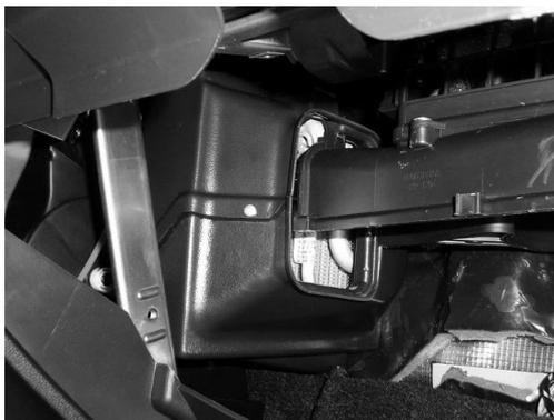
3.6.12 Установить вентилятор системы отопления в обратной последовательности. Загерметизировать место соединения блока испарительного и вентилятора системы отопления резиновым уплотнением (полосой) из комплекта поставки.
