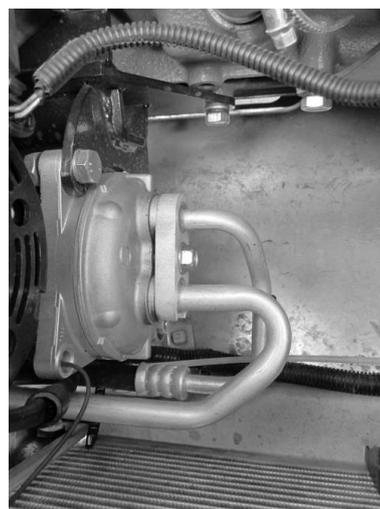
**Внимание.** Не допускается задевание рукавов хладопроводов об узлы и детали моторного отсека автомобиля.
